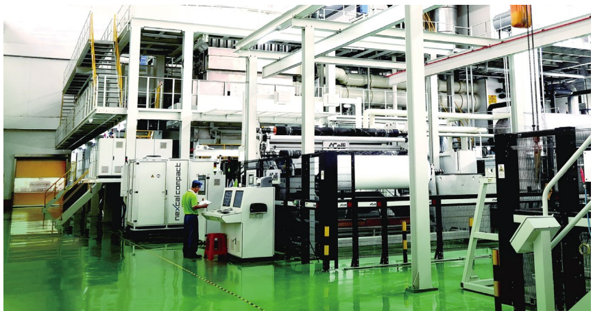
◆ 国机集团宏大研究院承建的“宏大 V 型”新型高速纺熔复合非织造布成套装备
