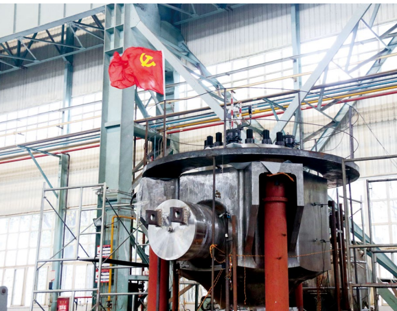
◆ 国机集团国机重装第三代核电泵壳内壁堆焊全自动焊接技术
